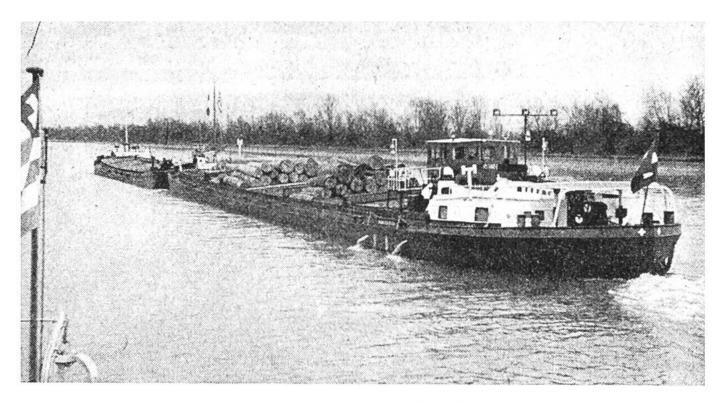
Beim neuartigen Schubverfahren wird der Kahn nicht geschleppt, sondern geschoben und damit der früher notwendige Steuermann auf dem Kahn eingespart.
