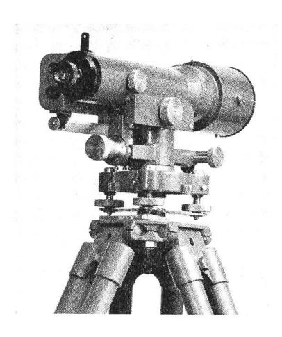
gangspunkt; in einem Abstand von höchstens 40-50 m wird das Instrument aufgestellt, und im gleichen Abstand nach vorn kommt noch eine Sind 2. Latte. die Ablesungen an diesen Latten gemacht, so können das Instrument und die hintere Latte nach
