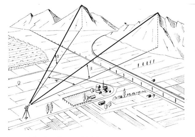
Schematische Darstellung der Winkelmessung.  $\alpha = \text{Horizontal winkel}, \ \beta = \text{H\"{o}}\text{henwinkel}.$
