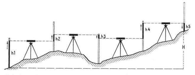
Prinzip der Höhenmessung mit Nivellierinstrument (Optische Treppe).  $H = h_1 + h_2 - h_3 + h_4 - h_5$ .
