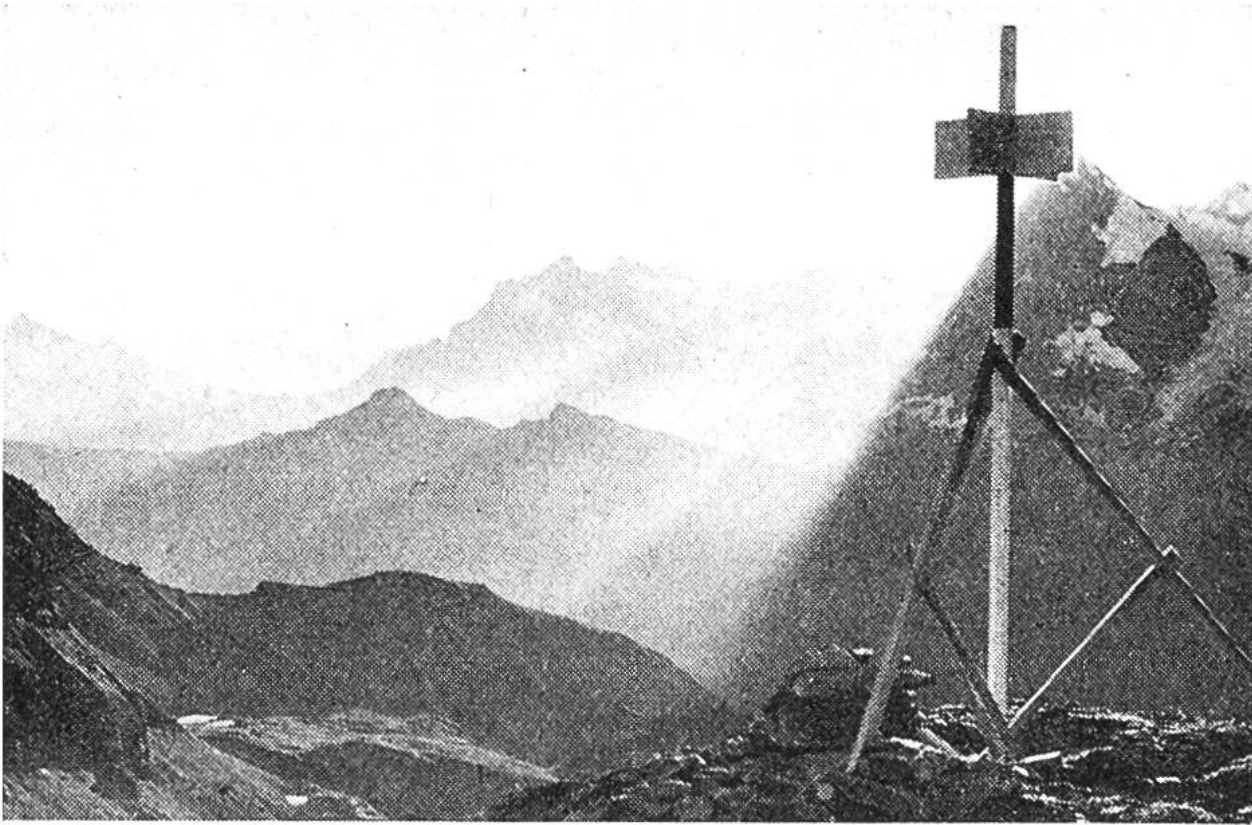
Triangulationssignal auf Berggipfel.
