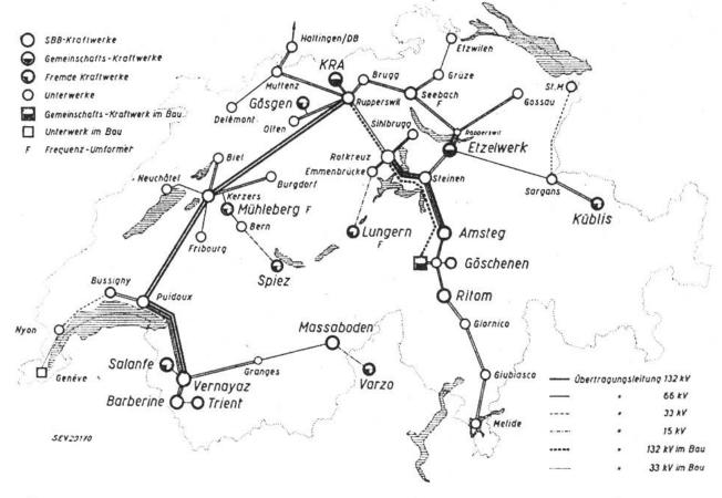
Übersichtsplan der Kraftwerke und Hochspannungs-Verteilleitungen des Netzes der Schweizerischen Bundesbahnen für das Bahnstromsystem von  $16^2/_3$  Hertz. Dieses Produktions- und Verteilsystem ist von demjenigen der allgemeinen 50-Hertz-Elektrizitätsversorgung getrennt.
