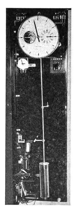
Die elektrische Mutteruhr des österreichischen Rundfunks in Wien. Die Uhr wird von der Wiener Sternwarte über eine Drahtleitung synchronisiert und löst auf elektrischem Wege einen Gongschlag mit der Genauigkeit von 0,2 Sekunde aus.
