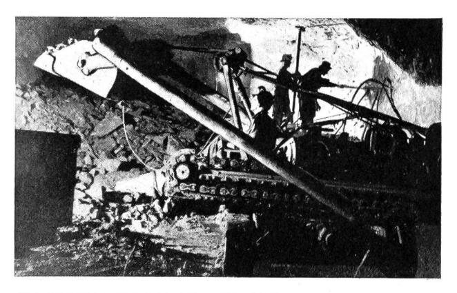
Erzlademaschine. Rechts der Abbau, links die Erzwagen.
