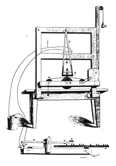
Der erste von Morse konstruierte Telegraphenapparat war unter Benützung von Teilen seiner Malerstaffelei zusammengesetzt.
