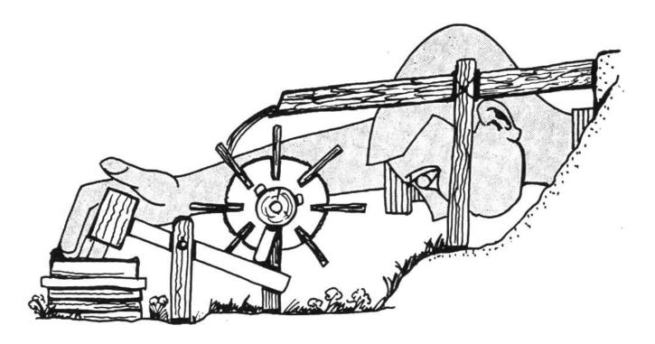
eine Druckleitung aus Rinde in den Damm eingesetzt. Der Wasserstrahl treibt nun das Wasserrad, das wir aus einer Holzscheibe und Schindeln hergestellt haben.
