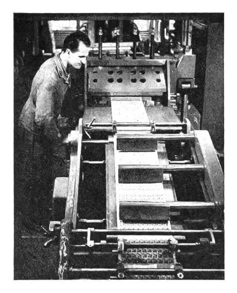
Stahlstich-Rotationsmaschine der PTT. Der Markenstrang passiert das Perforierwerk.
