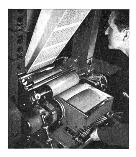
Das Farbwerk der Stahlstich-Rotationsmaschine der PTT.
