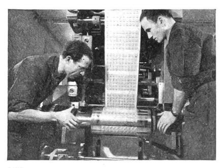
Einbauen des Druckzylinders in die Rotationsmaschine.
