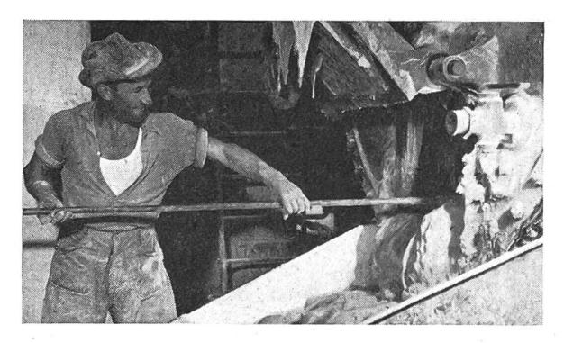
Die Linoleummasse, die nun sämtliche Zutaten enthält, wird in dieser Maschine geknetet.
