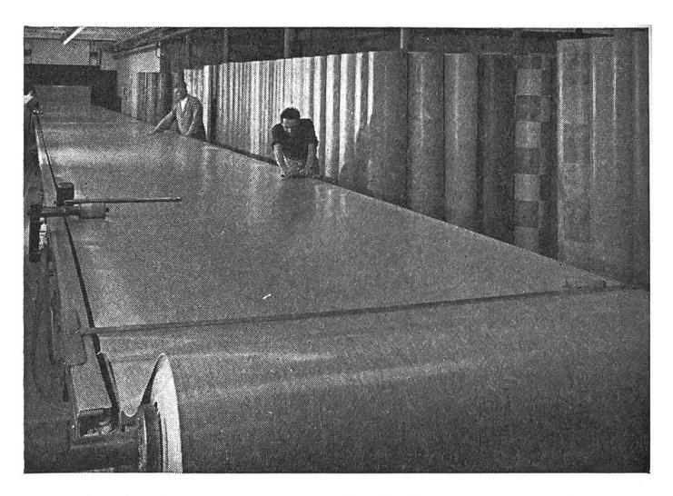
Die fertige Linoleumbahn wird geprüft und auf 2-m-Breite zugeschnitten.
