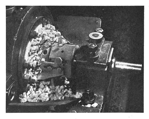
Die Masse des oxydierten Leinöls fliesst aus der Linoxyntrommel.
