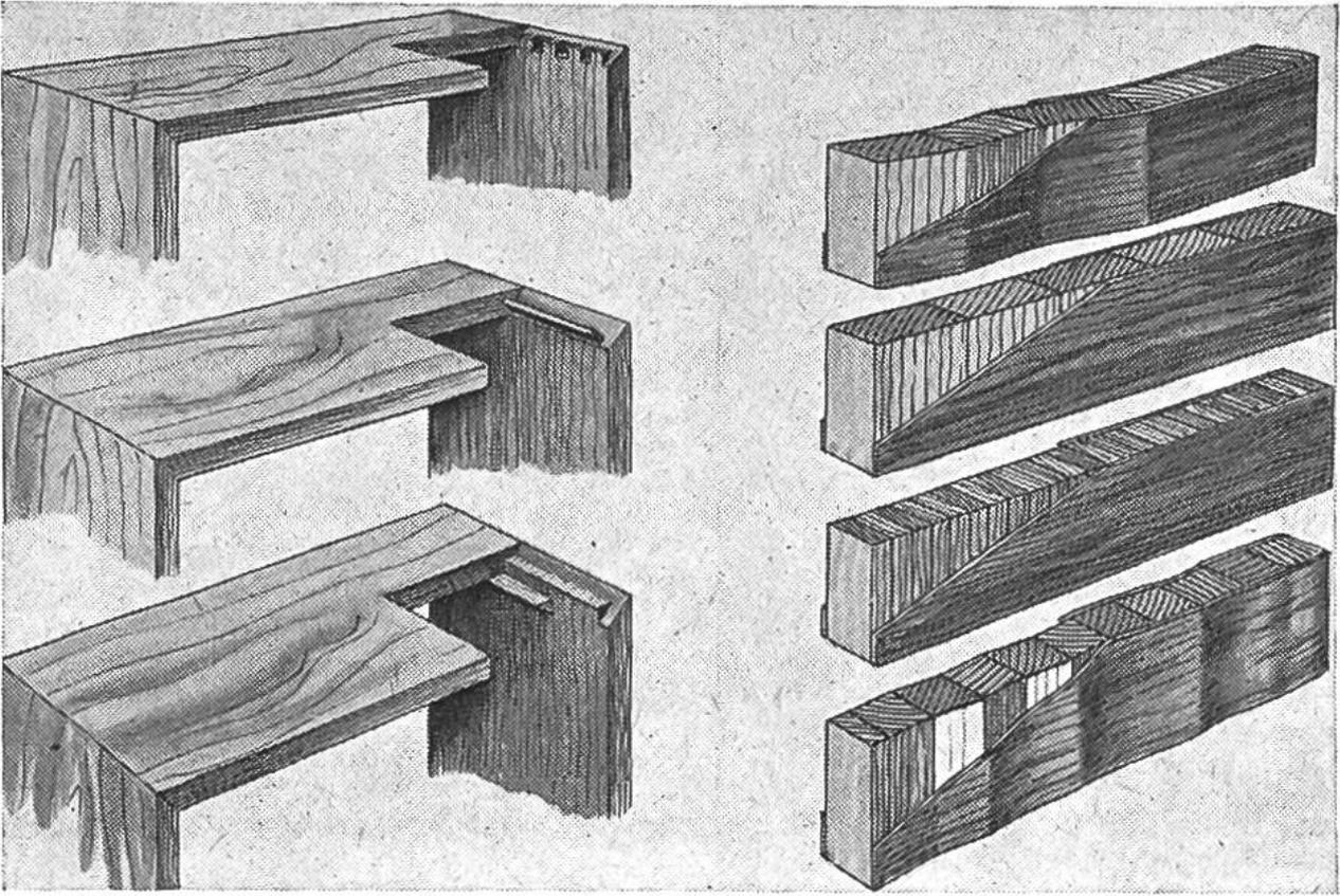
Der Schreinermeister zeigt dir auch, worauf es bei einem Qualitätsmöbel ankommt. Links: Gute und weniger gute Eckverbindungen. Rechts: Je nach dem Aufbau der «Mittellage», die durch Absperrfurniere und Aussenfurniere verdeckt wird, kann eine Türe aus dem gleichen Material eben bleiben oder aber krumm werden.
