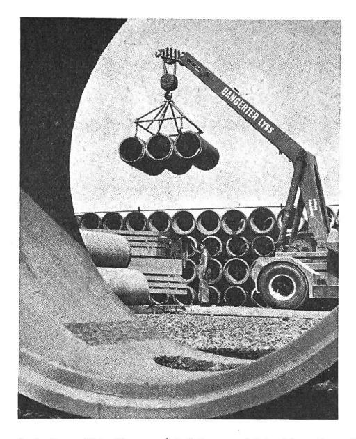
Starke und sehr bewegliche Krane ermöglichen es, gleichzeitig mehrere Zementrohre zu verladen.
