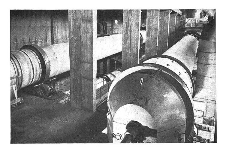
Drehofenanlagen einer Zementfabrik. Bei der Konstruktion moderner Brennöfen ist man darauf bedacht, möglichst wenig der kostbarenWärmeenergie zu verlieren. An beiden Enden der Drehöfen schliessen sich Wärmeaustauscher an, in denen die Abgase das zufliessende Rohmaterial und der glühende Klinker die zuströmende Verbrennungsluft vorwärmen.
