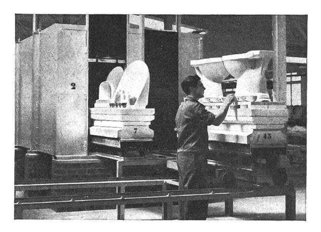
Auf kleinen Wagen fahren die geformten und getrockneten Waschtische und Klosetts zum Brennen in den Tunnelofen ein.
