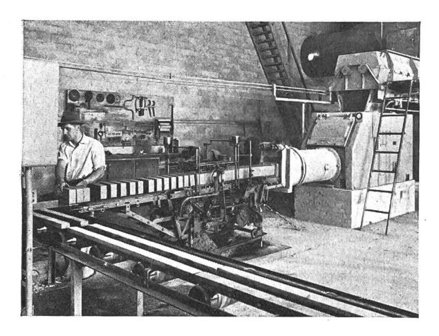
Der homogenisierte, plastische Lehm wird durch ein Mundstück gepresst und verlässt die Presse als fortlaufender Strang mit spezifischer Form und Lochung. Im anschliessenden Schneideapparat wird er durch einen Draht auf die gewünschte Stückgrösse geschnitten.
