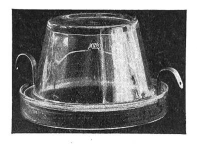
Nachbildung einer Groveschen Platindrahtlampe von 1845. Das Gefäss wurde vor der Inbetriebnahme mit Wasser gefüllt und dann umgestülpt, um den (als Spirale sichtbaren) Platindraht dem oxydierenden Einfluss des Luftsauerstoffes zu entziehen. Lampe gebaut für eine Spannung von 4 Volt und einen Strom von 10 Ampere.
