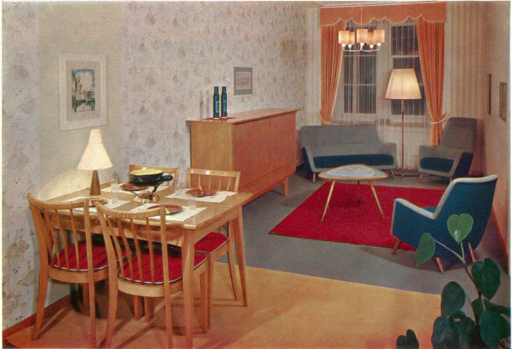
Zweckmässige moderne Wohnraumbeleuchtung, bestehend aus einem Leuchter für die Allgemeinbeleuchtung, einer Ständerlampe als Leselampe und einer Tischlampe als Arbeitsplatzleuchte. (Aufnahme bei B. Biasiutti, Zürich.)
