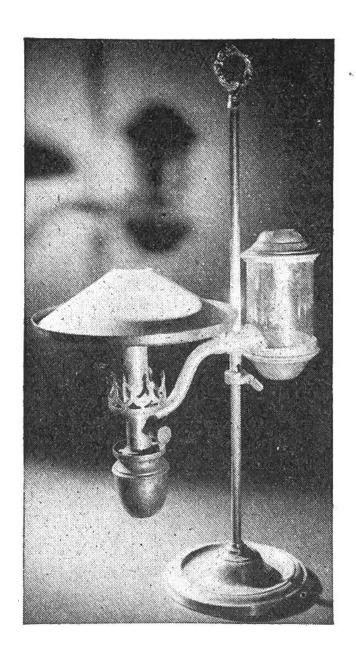
«Moderator»-Lampe aus dem 19. Jahrhundert. Mit übergeordnetem Ölbehälter, an Rändelschraube regulierbarem Docht und «Schirm» als Lichtreflektor. Geeignet sowohl als Tischlampe als auch zum Aufhängen am Tragring.
