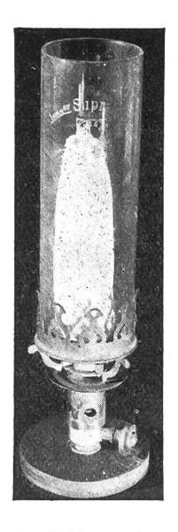
Gaslampe mit Glühstrumpf aus dem 19. und 20. Jahrhundert. Als Brennstoff diente «Leuchtgas», heute Stadtgas genannt, aus dem Gaswerk. Die grosse Helligkeit und Lichtfülle wurde dadurch ermöglicht, dass die an einer Rändelschraube regulierbare Gasflamme einen «Glühstrumpf» zur Weissglut brachte und dieser dann ein helles Licht abgab.
