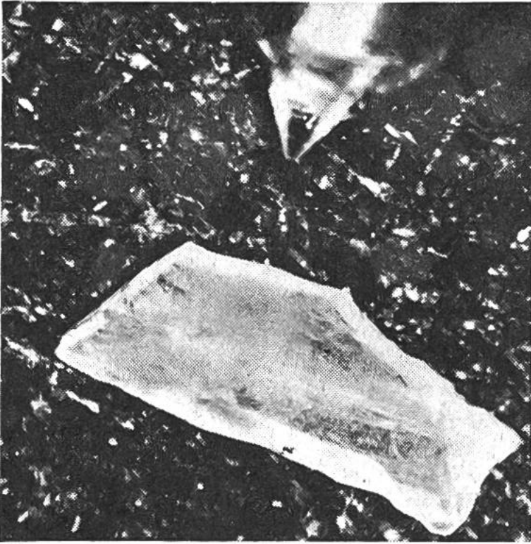
So sieht ein künstlich erzeugter Diamant von ca. 1\frac{1}{2} mm Länge in starker Vergrößerung aus. Für den praktischen Bedarf genügen meistens noch kleinere Diamanten oder Splitter, wie die gleichfalls abgebildete Diamantennadel eines Schallplatten-Pick-ups (oben) zeigt.
