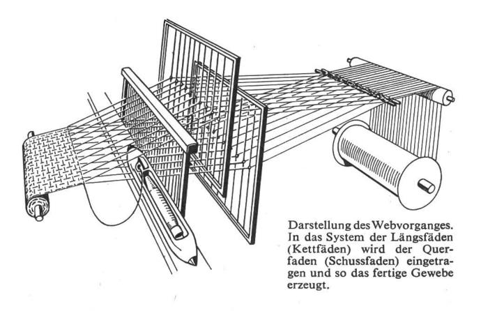
Nun muss der eingezogene Faden aber an den gleich vorher eingetragenen angedrückt werden; dies geschieht mit einem Kamm, hier Blatt genannt, der zwischen die Längsfäden greift und den Schussfaden an den Geweberand drückt. Je nachdem, in welcher Reihenfolge man die einzelnen Längsfäden hoch- und tiefzieht, entstehen ganz verschiedene Muster. Man hat aber noch weitere Musterungsmöglichkeiten, indem man verschiedenfarbiges und vielleicht auch noch unterschiedlich dickes Garn verwendet.
