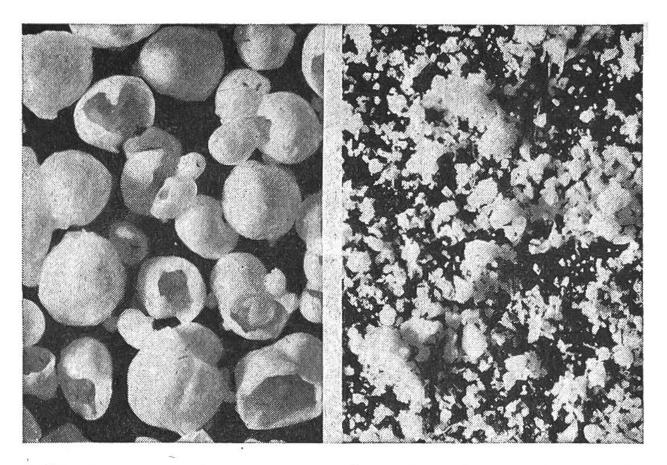
Mikrophotos von zwei Waschpulvern. Links: heiss zerstäubtes, gibt gut lösliches, nicht stäubendes Pulver mit Hohlkugelstruktur. Rechts: kalt zerstäubtes, gibt langsamer lösliches, sehr feines jedoch stark stäubendes Pulver mit Vollkornstruktur.
