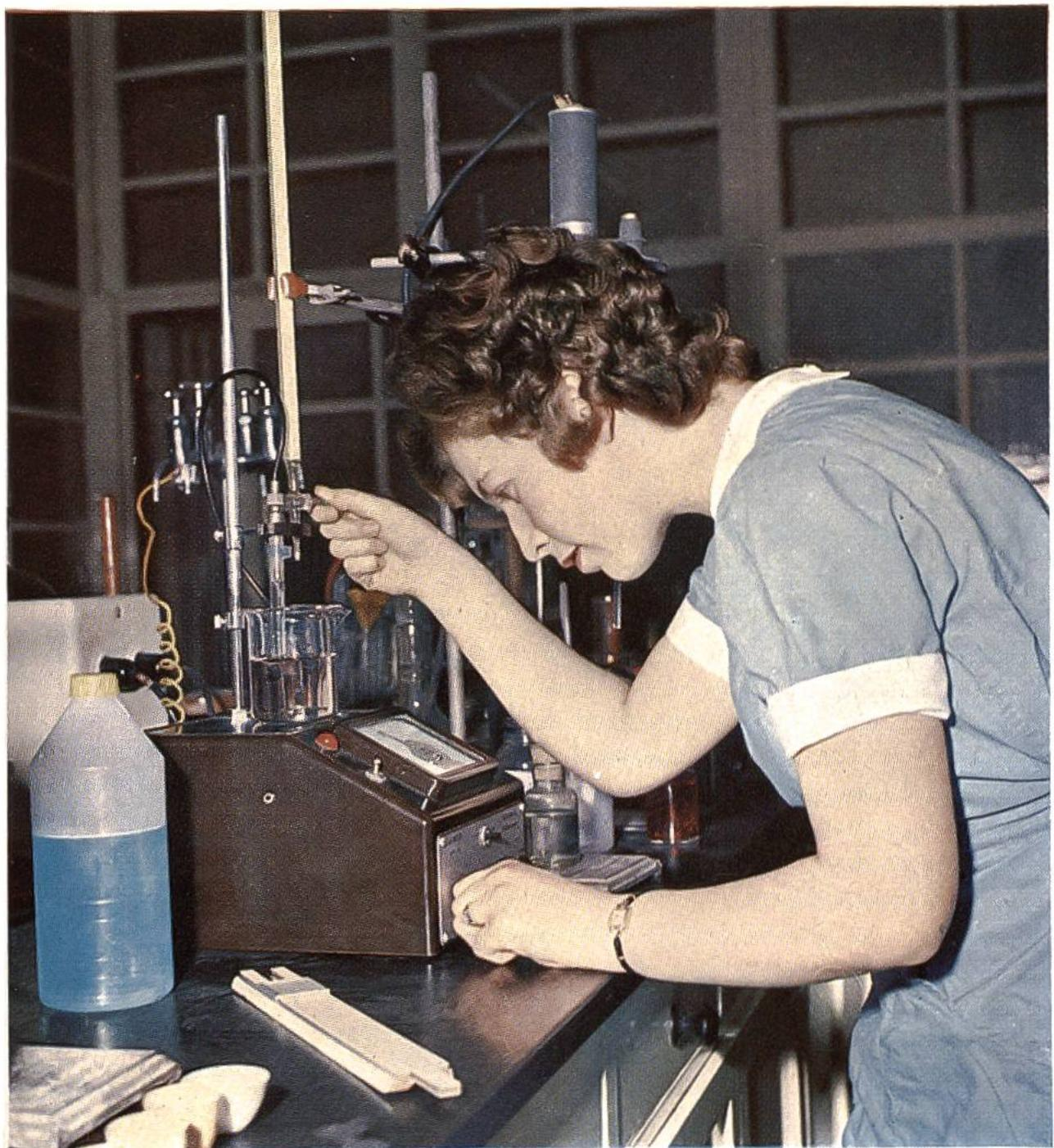
Zur Feststellung der Qualität eines Waschpulvers ist u. a. die Bestimmung der Alkalität von grosser Wichtigkeit (s. S. 248).
