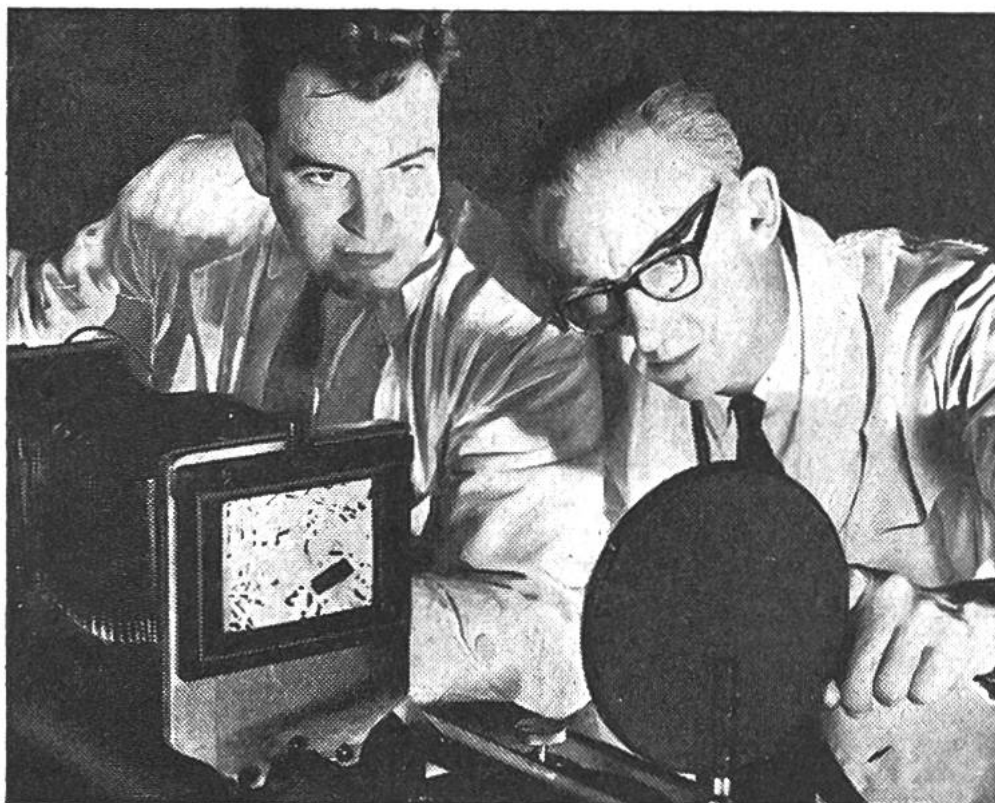
Untersuchung eines Legierungsschliffs auf dem Metall-Mikroskop.
