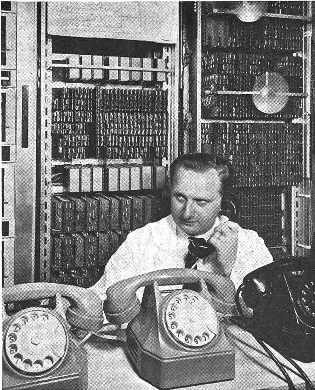
Die Telephonzentrale der Zukunft ist heute bereits im Laboratorium vorhanden. Statt der relativ grossen, langsamen und dem Verschleiss unterworfenen Relais werden Halbleiterelemente (Dioden, Transistoren) verwendet.
