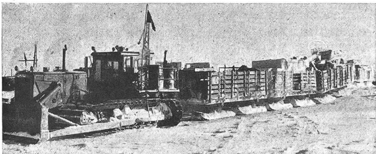
Schwere Traktoren ziehen Lastschlitten, gross wie Eisenbahnwagen, 1000 km weit über das Inlandeis der Westantarktis zur Byrd-Station.
