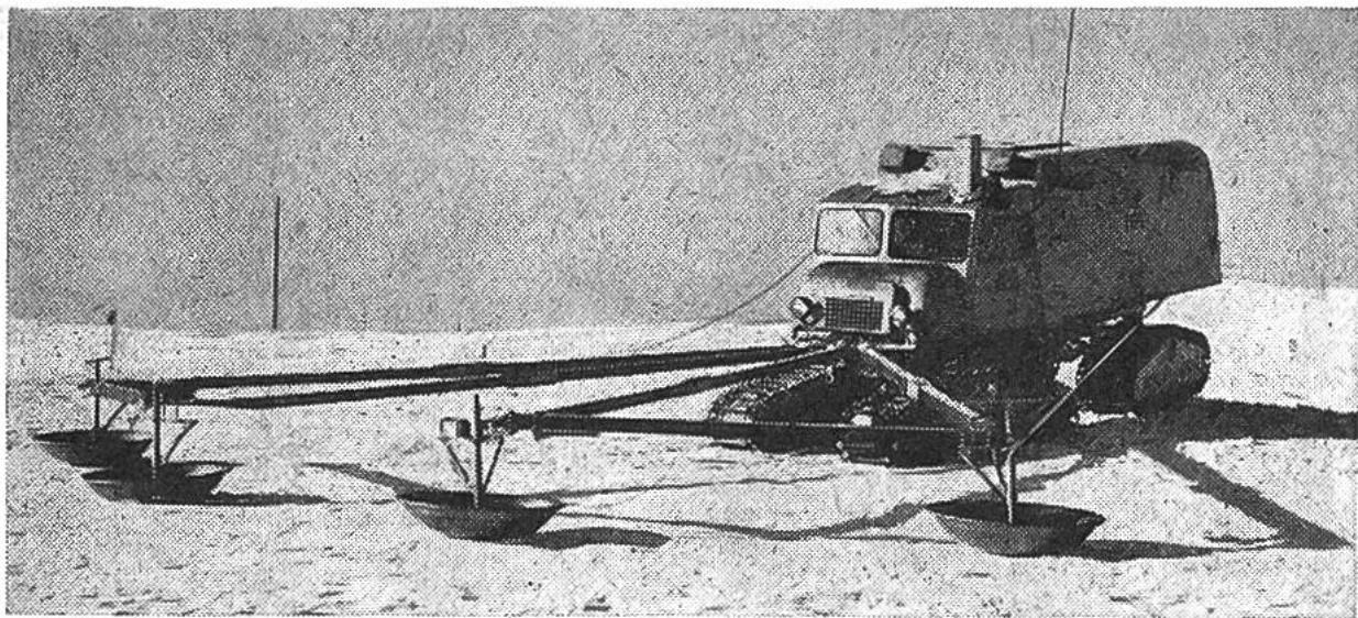
Das Gestell, das die «Snow-cat» vor sich herschiebt, ist ein elektrischer Spalten-detektor, mit dessen Hilfe es häufig gelingt, unter der Schneedecke verborgene tückische Gletscherspalten rechtzeitig zu erkennen.
