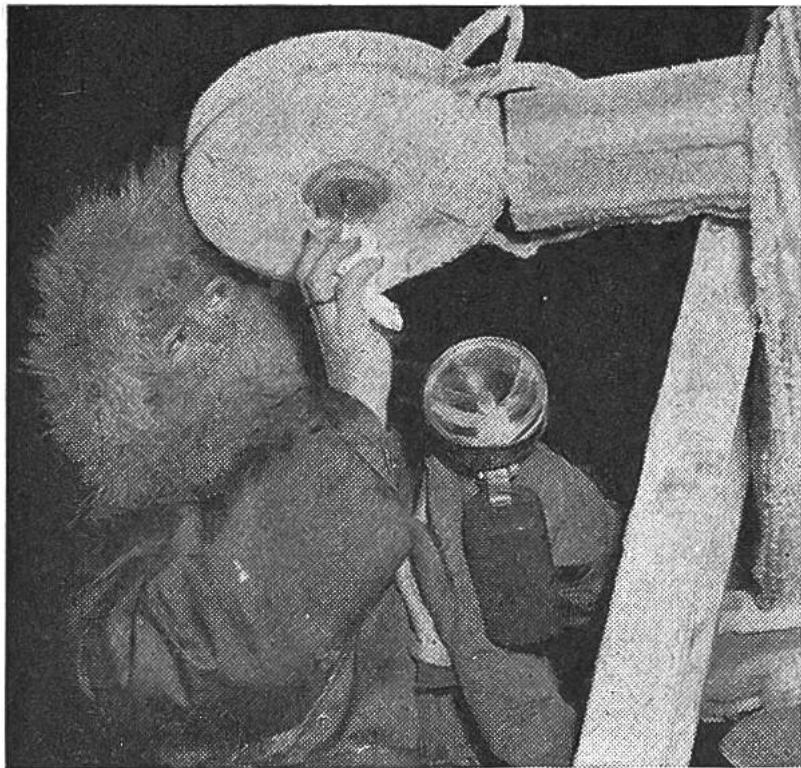
Täglich oft mehrere Male müssen die sehr empfindlichen Strahlungsmessgeräte vom Reifansatz befreit werden. Das ist bei Temperaturen unter  $-30^{\circ}\text{C}$  und Wind eine kalte Beschäftigung, zumal es ohne Handschuhe geschehen muss.
