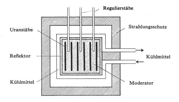
Schema eines Atomreaktors, auch Kernreaktor genannt.
