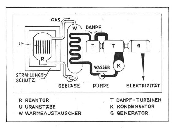
Schema eines Atomkraftwerkes mit gasgekühltem Reaktor.
