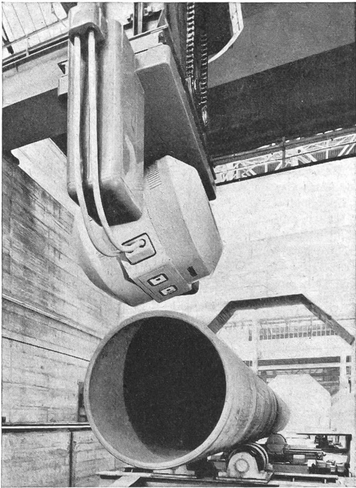
Dieser 30 m lange und 10 m breite Prüfraum für das Durchstrahlen von Stahlrohren, insbesondere zur Untersuchung von Schweißnähten, befindet sich in einem Röhrenwerk. Über dem zu prüfenden Stahlzylinder ist ein drehbares Brown Boveri Zweistrahl-Betatron an einem besonderen Kran aufgehängt. Es liefert Röntgenstrahlen von 31 MeV (Millionen Elektronenvolt) und gestattet das Aufnehmen sogenannter Breitfeld-Stereo-Radiographien.
