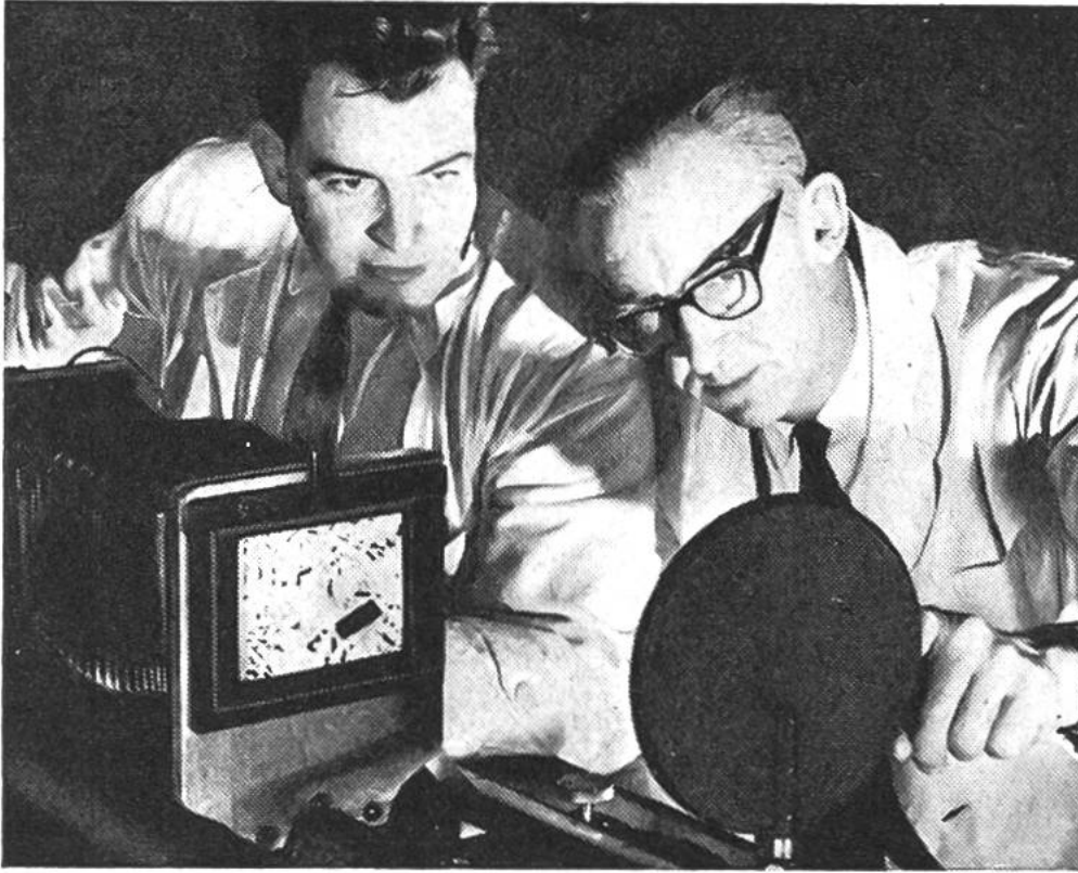
Untersuchung eines Legierungsschliffs auf dem Metall-Mikroskop.
