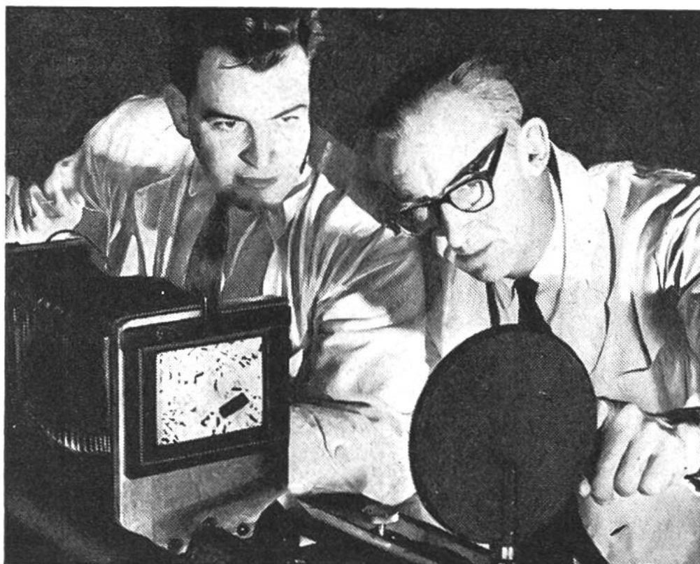
Untersuchung eines Legierungsschliffs auf dem Metall-Mikroskop.
