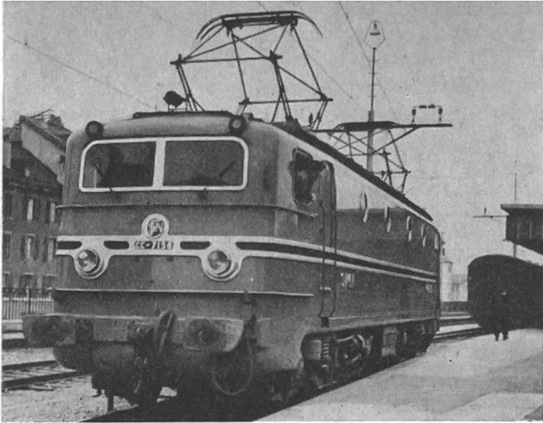
Französische 6achsige Gleichstromlokomotive. Die Aufnahme wurde im Bahnhof Genf gemacht, welcher teilweise mit 1500 Volt Gleichstrom elektrifiziert ist.
