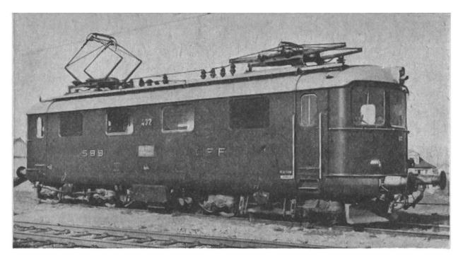
Re 4/4-Lokomotive der Schweizerischen Bundesbahnen, deren elektrische Ausrüstung nach dem Schema auf Seite 289 gebaut ist.
