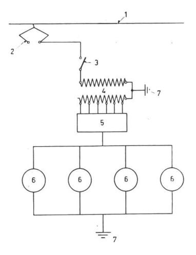
Vereinfachtes Hauptstromschema einer  $16^2/_3$ -Hz-Lokomotive mit vier Fahrmotoren. Der Strom fliesst dabei von der Fahrleitung (1) über den Stromabnehmer (2) und den Hauptschalter (3) zum Transformator (4). Mit Hilfe eines Stufenschalters (5) können die Fahrmotoren mit verschiedenen Abzapfungen am Transformator, d.h. mit verschiedenen Spannungen, verbunden werden. Von den Fahrmotoren fliesst der Strom über die Räder und die Schienen (7) zum Un-
