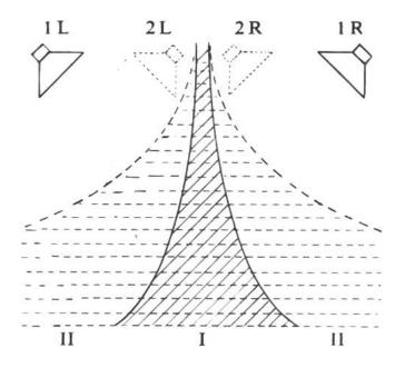
Die stereophonische Wiedergabe erfordert mindestens zwei Lautsprecher. Werden die Beiden Lautsprecher 1L und 1R in ca. 2½ m Entfernung voneinander aufgestellt, so ist die nutzbare Hörfläche I, innerhalb deren die Zuhörer den räumlichen Klangeindruck trompetenförmig empfinden, und schmal. Durch ein zusätzliches Lautsprecherpaar und 2R, die näher der Mittellinie postiert sind, wird die Hörfläche II verbreitert.
