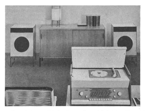
Eine moderne Anlage zur Wiedergabe von Stereo-Schallplatten. Vorne neben dem Sitz des Zuhörers steht ein Radioapparat mit Plattenspieler und eingebautem Zweikanalverstärker. Hinten links und rechts vom Buffetschrank zwei Lautsprecherkombinationen. (Braun, Frankfurt a. M.)
