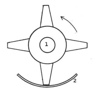
Bei der Ampex-Bildaufzeichnungsanlage rotieren vier Magnetköpfe (1) mit 14 400 Umdrehungen in der Minute quer zu einem Magnetband (2) von 5 cm Breite, das sich gleichzeitig um 37,5 cm in der Sekunde vorschiebt. Dadurch werden die Bildsignale in eng aneinanderliegenden Querzeilen auf dem Band festgehalten.
