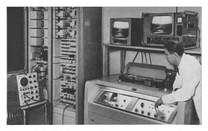
Die magnetische Bildaufzeichnungsanlage, System Ampex-Siemens, dient zur Aufnahme und Wiedergabe von Fernsehhprogrammen auf einem 5 cm breiten Magnetband. Auf dem Pult ist die geöffnete Abspulvorrichtung für das Magnetband zu sehen. Vorne die Bedienungsknöpfe und Schalter, über dem Pult die Kontrollempfänger. Links stehen die geöffneten Schränke und ein Oszillograph für die Verstärker, Mess- und Speisegeräte und sonstigen elektronischen Einrichtungen.
