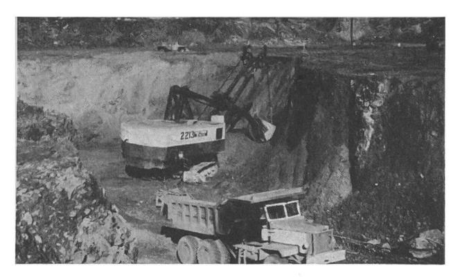
Abbau des losgesprengten Eisenerzes mit Baggern.
