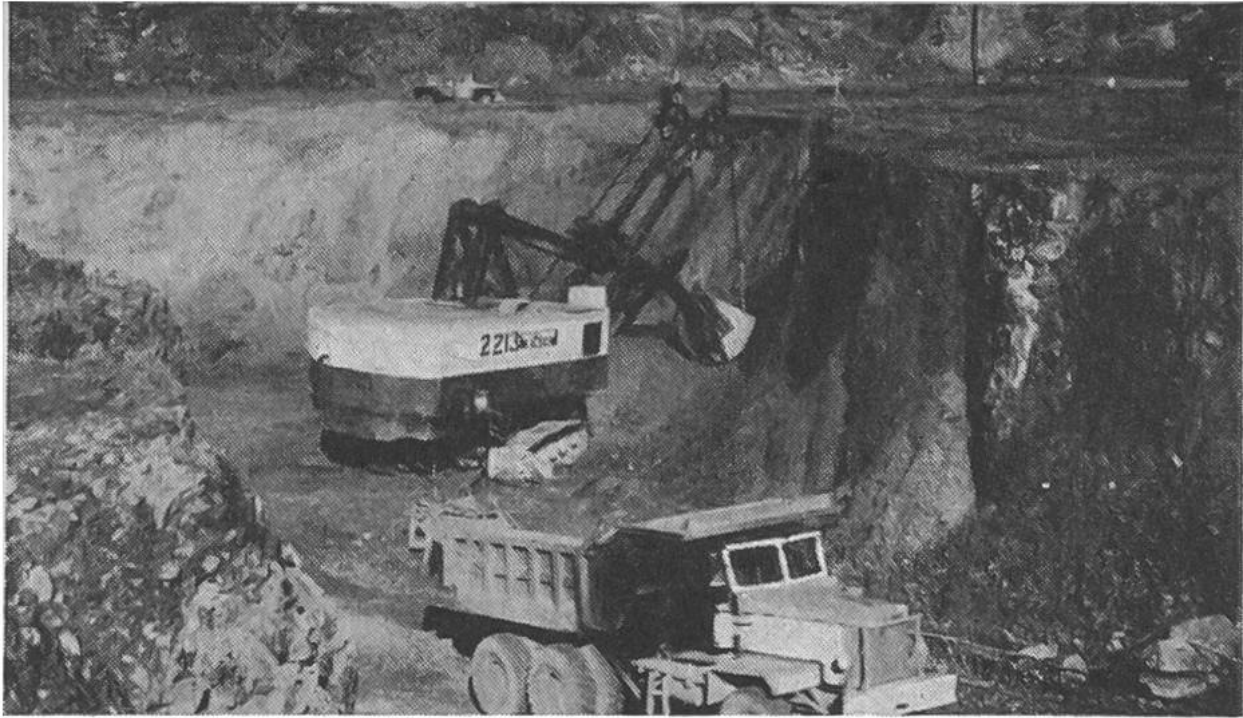
Abbau des losgesprengten Eisenerzes mit Baggern.
