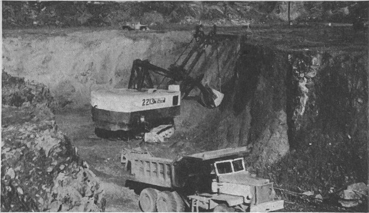
Abbau des losgesprengten Eisenerzes mit Baggern.
