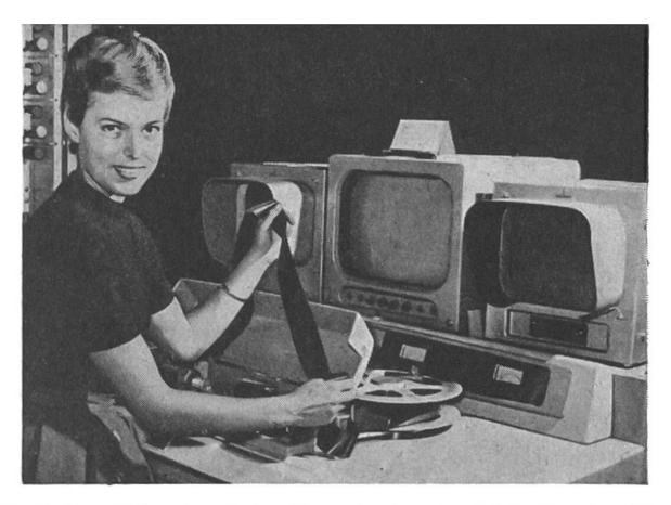
Die Spulen mit dem 5 cm breiten Magnetband werden auf die Abspulvorrichtung des Ampex-Gerätes gesetzt und das Band über Rollen geführt, die es an den rotierenden Magnetköpfen vorbeiziehen. Auf dem Pult stehen die Kontrollempfänger, mit denen die Wiedergabe des Fernsehbildes überwacht wird.
