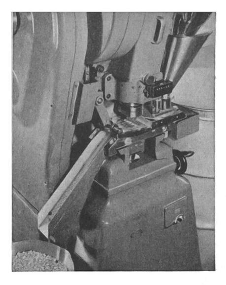
Komprimiermaschine Mit einem Druck von mehreren Tonnen werden die trockenen Substanzen zu Tabletten gepresst. Aufnahmen aus der
