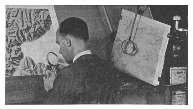
Das Relieforiginal wird unter Verwendung von Pressluft mit einem feinen Spritzapparat, mit Pinsel und Bleistift gemalt und gezeichnet. Auch hier arbeitet der Kartograph mit der Lupe in der Hand.
