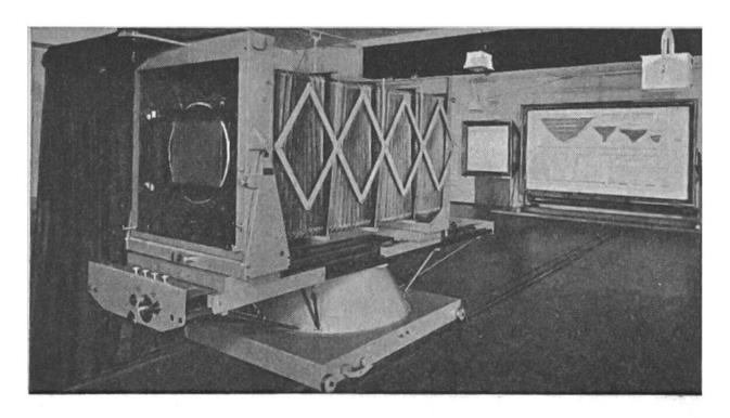
Eine Photokamera für die Kartenreproduktion. Plattenformat 1 m².
