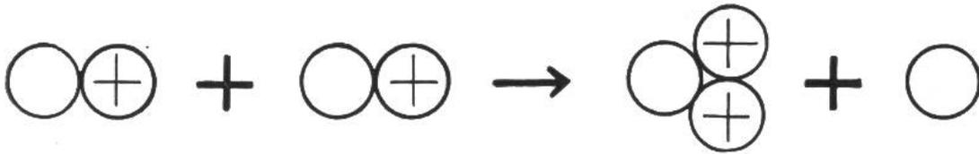
Durch Kernfusion entstehen aus zwei Deuteronen ein Helium3-Kern und ein Neutron, unter Abgabe von Wärme und Strahlung.
