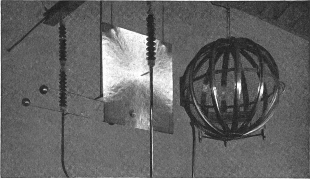
Links: Versuch zur Ermittlung des Einflusses einer Glasplatte zwischen zwei Spitzen: Die Entladung erfolgt um die Platte herum!
