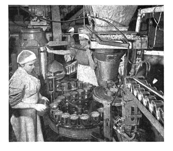
Automatische Abfüll- und Verschlussmaschine für Konservenerbsen. Die leeren Büchsen (von rechts anrollend) werden durch den grossen Trichter mit Erbsen gefüllt und von da zu dem Teil der Maschine geleitet, der ihnen den Deckel aufpresst. So werden pro Minute über 100 Büchsen abgefüllt und verschlossen!
