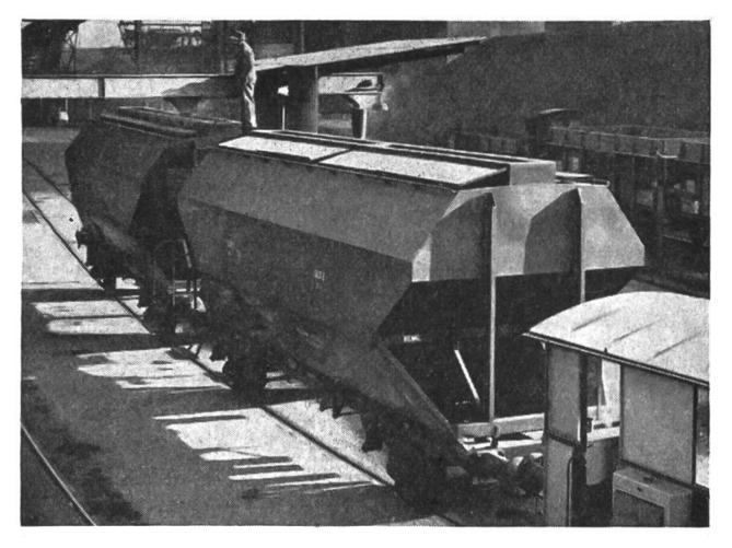
Der neue Silowagen der SBB, welcher 25-28 t Getreide transportieren kann, wird hier gefüllt. Das Getreide fällt vom Silo durch eigene Schwerkraft in ein Auslaufrohr und wird mit einem Trichter von oben her in den Wagen geleitet. Das Füllen des Wagens dauert ungefähr 15 Minuten. – Das Entladen des Wagens ist ebenso einfach: das Getreide fliesst durch zwei Bodenlucken von selbst aus dem Wagen und gelangt über die Förderanlagen zu den Silos.
