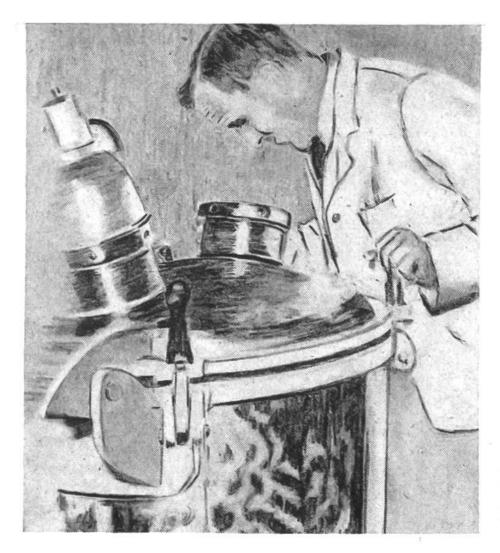
Überwachung des Uperisationsvorganges am Expansionsgefäss.
