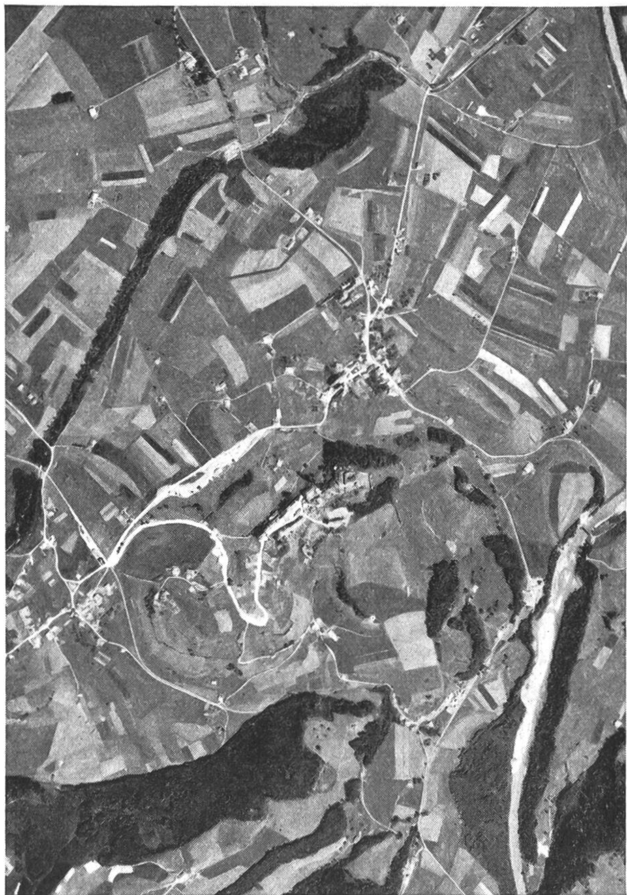
3. Fliegeraufnahme der Eidg. Landestopographie: Flughöhe 6000 m ü/Meer, Wild-Kamera mit Objektiv Aviotar 210 mm. Neben an: Der gleiche Bildausschnitt auf der Landeskarte.
