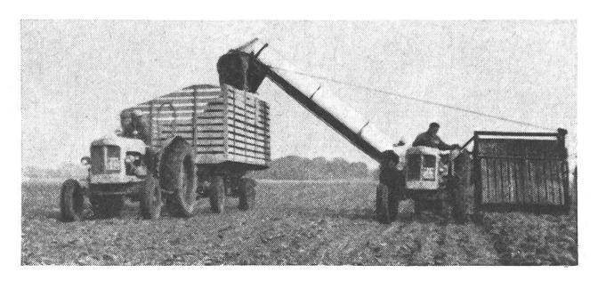
Zur Spinaternte fahren 2 Traktoren auf das Feld. Der eine zieht die Erntemaschine, der andere den Anhänger. Vorn an der Erntemaschine ist ein 2 m breiter Messerbalken (wie bei einer Grasmähmaschine), welcher den Spinat schneidet. Ein Transportband befördert die geschnittenen Blätter mit einem Elevator in den nebenanfahrenden Anhänger. Der Elevator muss geschlossen sein, damit der Wind die Blätter nicht fortbläst.
