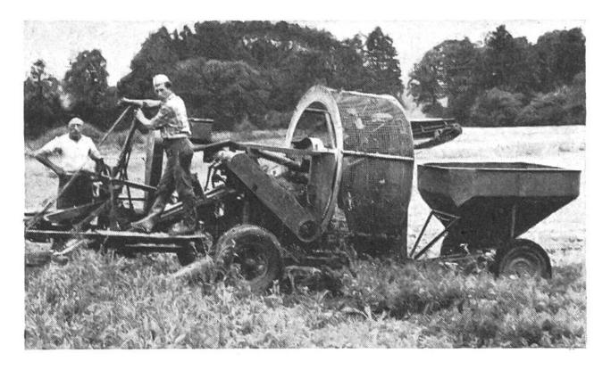
Karotten-Erntemaschine. Die Schaufel unten hebt die Karotten aus dem Boden, zwei Keilriemen fassen diese am Kraut und befördern sie zu 2 Messern, die das Kraut abschneiden. Die Karotten fallen dann auf ein Transportband und gelangen in eine Trommel, worin sie von Erde gereinigt werden. Ein Transportband befördert sie danach in den Anhänger.
