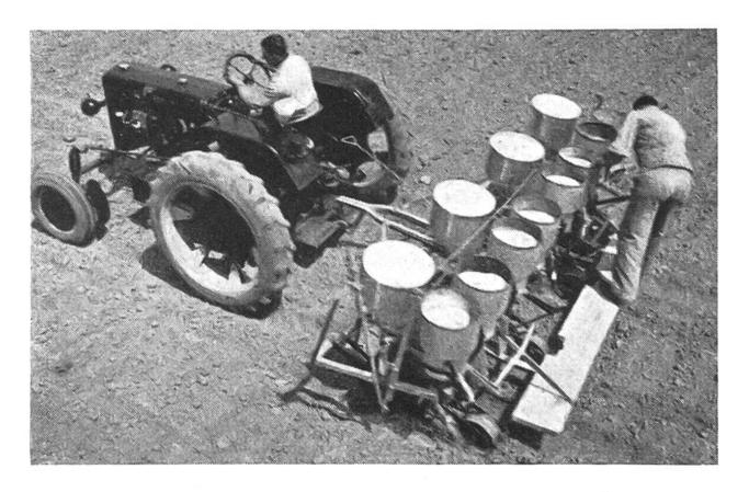
Bohnenaussaat. Mit einer solchen Maschine geht das Säen der Bohnen sehr viel schneller als mit der Hand. Vorn sind 4 Töpfe mit Samen, hinten 8 mit Dünger. Die unten angebrachte Säschare zieht im Boden eine Rille, in die der Samen fällt, auf beiden Seiten der Rille wird Dünger gestreut. Das kleine Rad dahinter ist eine Druckrolle, welche den Samen zudeckt und die Erde andrückt.
