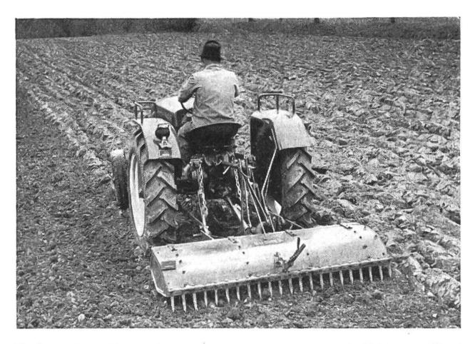
Traktor mit Zapfwellen-Spatenegge bei der Vorbereitung des Feldes zum Säen.
