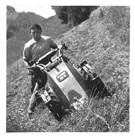
Motormäher mit tiefer Schwerpunktlage am Steilhang. Hier wurde bis vor kurzem mit der Sense gemäht. Der Mann leistet mit dem Motormäher soviel wie 6 kräftige Mähder.
