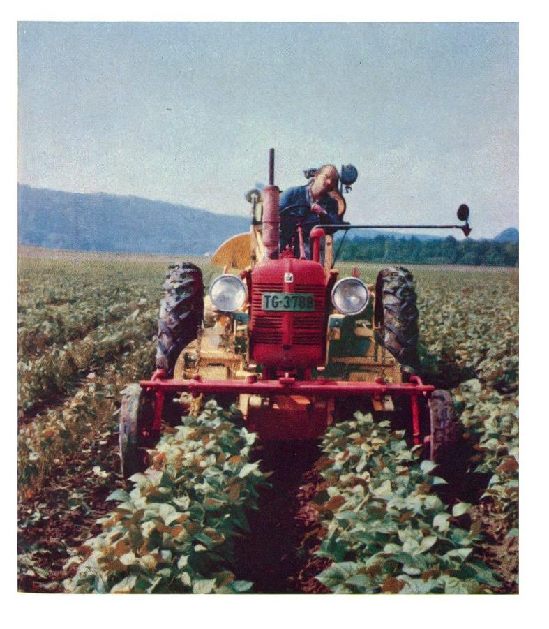
Bohnenernte. Der Apparat zum Bohnenpflücken ist mit dem Traktor verbunden; dieser fährt durch das Feld und pflückt zwei Reihen in einem Arbeitsgang. Mitte und rechts volle Stauden, links abgeerntete. (Siehe Seiten 213–221.)
