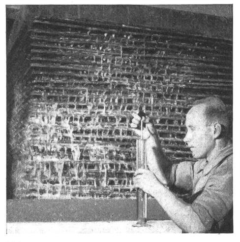
Köstliche Ströme von Obstsaft fliessen! Aus den zu Mus vermahlenen und zwischen feste Tücher gepackten Früchten wird mittels der hydraulischen Presse der Saft Der gewonnen. Moster kontrolliert mit Hilfe der Oechslewaage den Zuckergehalt des Saftes. (Photo Ernst Brunner, Luzern).
