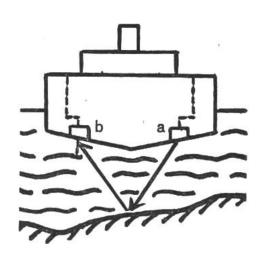
Eine Welle dreht sich mit konstanter Geschwindigkeit, wobei regelmässig ein Kontakt geschlossen wird. Ein Sender a im Schiffsboden schickt nun Impulse (hörbare Töne oder Ultraschall) aus, die bei einer Geschwindigkeit von ca. 1500 m/sek. nach wenigen Sekunden vom Meeresboden reflektiert zum Empfänger b zurückkehren und eine Neonröhre, die sich inzwischen mit der
