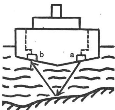
Eine Welle dreht sich mit konstanter Geschwindigkeit, wobei regelmäßig ein Kontakt geschlossen wird. Ein Sender a im Schiffsdeck schickt nun Impulse (hörbare Töne oder Ultraschall) aus, die bei einer Geschwindigkeit von ca. 1500 m/sec. nach wenigen Sekunden vom Meeresboden reflektiert zum Empfänger b zurückkehren und eine Neonröhre, die sich inzwischen mit der
