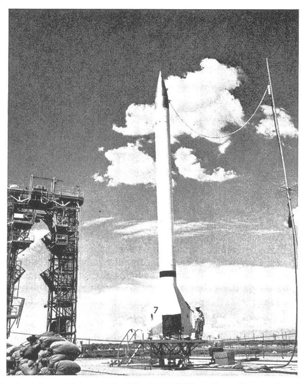
Eine Forschungsrakete vom Typ Martin VIKING wird zum Start vorbereitet. Sie erreicht Höhen bis 220 000 m. Mehrstufige Ausführungen, d.h. solche, bei denen eine weitere Rakete bereits in grosser Höhe von einer Mutterrakete aus startet, haben Höhen von mehr als 400 000 m überschritten. Je nach Forschungsaufgabe befinden sich Kameras, meteorologische Geräte oder andere wissenschaftliche Geräte im Raketenkopf, der an einem Fallschirmsystem gelandet wird.
