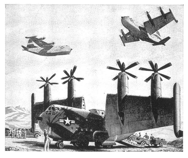
Startstrecke 0 Meter! Ein in Amerika entwickeltes Transportflugzeug sieht einen Kippflügel vor, der die überstarken Propellerturbinen in vertikale Lage bringt und deren Propeller als Tragschrauben benützt.
