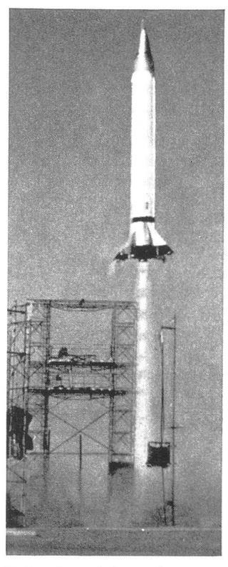
Fünf – vier – drei – zwei – eins – Feuer! Mit gewaltigem Getöse hebt sich die VIKING vom Boden, um bald mit einer Geschwindigkeit von 6600 km/h himmelwärts zu schiessen. Die Perlenschnur unter der Rakete bildet sich durch Verdichtungsstösse, die von den mit Überschallgeschwindigkeit auf die ruhende Aussenluft aufprallenden Verbrennungsgasen gebildet werden.
