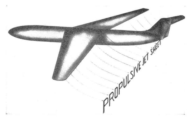
Die Lösung für die Zukunft heisst JETFLAP. Die ausströmenden Triebwerksgase werden nicht mehr durch einzelne Düsen, sondern durch einen Schlitz in der Flügelhinterkante ausgestossen, wodurch sich eine unsichtbare, gasförmige Tragflächenvergrösserung ergibt, die es gestattet, schwere Grossflugzeuge mit der Geschwindigkeit eines Sportzweisitzers zu starten und zu landen. Die Entwicklung steht aber noch in Kinderschuhen, und bis zur praktischen Anwendung werden noch einige Jahre vergehen.
