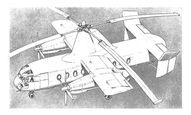
Beim Fairey Rotodyne werden die Vorteile des Helicopters mit denjenigen des Normalflugzeuges kombiniert. Die Maschine landet und startet als Helicopter und fliegt dann horizontal halb als Starrflügler, halb als Autogiro.
