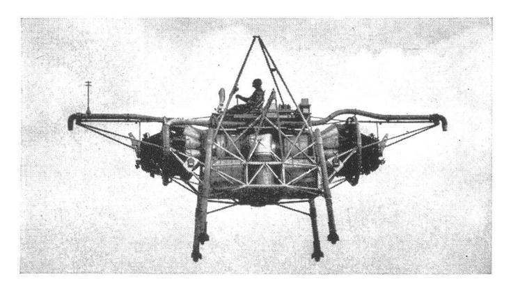
Die «Fliegende Bettstatt» von Rolls-Royce auf einem Testflug. Dieses Fluggerät besteht praktisch nur aus zwei Düsentriebwerken, die mehr Schub abgeben, als sie Gewicht aufweisen.
