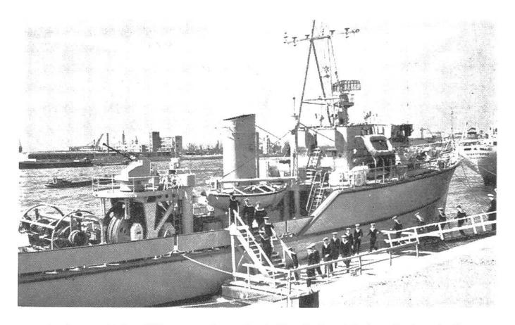
Antimagnetisches Minenräumboot der holländischen Marine. Es besteht fast zu 100% aus Schweizer Aluminium. Bei einem stählernen Boot würden die empfindlichen Instrumente einer Mine ansprechen und sie zum Explodieren bringen.
