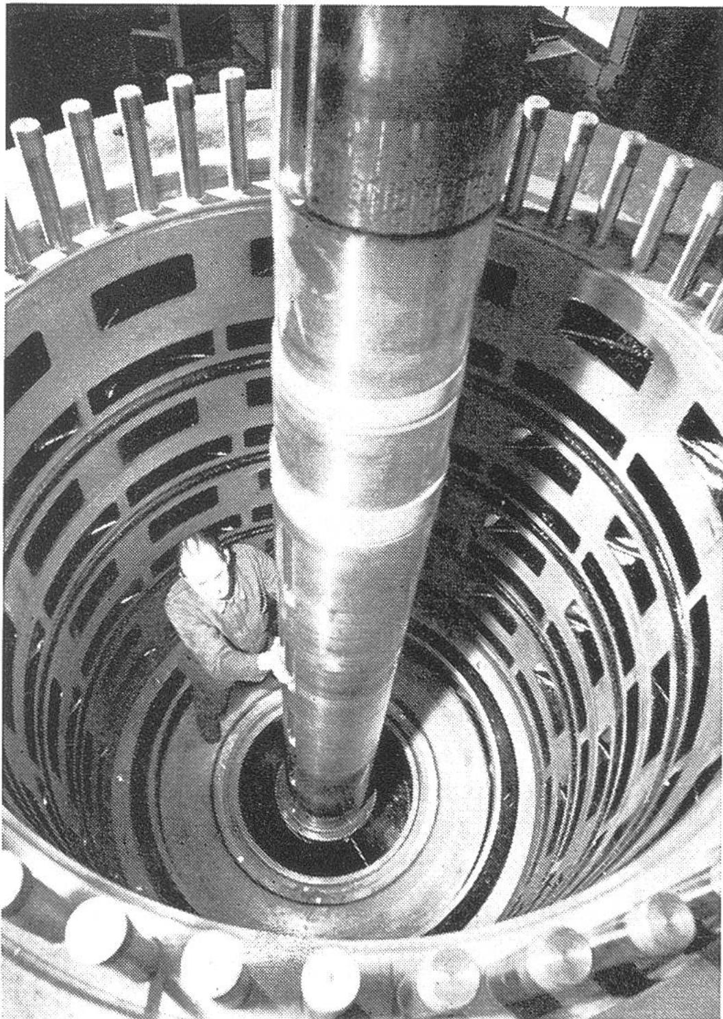
Einbau der Welle von 420 mm Durchmesser und 5350 mm Länge einer fünfstufigen Hochdruck-Speicherpumpe in den Sulzer-Werkstätten in Winterthur. Vier derartige, jedoch bedeutend größere Pumpen sind für eine Speicheranlage in Nordwales bestimmt.
