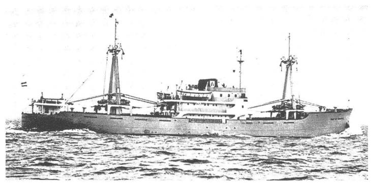
Das französische Frachtschiff M/S Ville de Montréal ist mit einer Antriebsanlage (Dieselmotoren) von 2500 PS der Schweiz. Lokomotiv- und Maschinenfabrik in Winterthur ausgerüstet. Es ist 78,6 m lang, besitzt eine Ladefähigkeit (dw) von 2800 t und wird sowohl im Atlantik als auch auf den kanadischen Seen eingesetzt.
