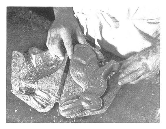
Herstellen von Osterhasen. Die auf dem Bild sichtbare Form wurde zuerst teilweise mit flüssiger Schokolade gefüllt, dann geschlossen und von einer Spezialmaschine so lange gekehrt und gewendet, bis sich die Schokolademasse an der Wand und in allen Ecken festgesetzt hat. Nach dem Abkühlen kann der Osterhase, wie auf dem Bild sichtbar, leicht aus der Form gehoben werden.
