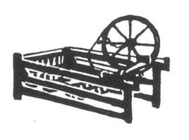
1764 baute James Hargreaves, ein armer englischer Weber, nach mühseligen Versuchen die erste brauchbare Spinnmaschine, die gleichzeitig 8 Fäden spann. Er nannte sie nach seiner Tochter «Jenny-Maschine». Arbeiter, die durch die neue Maschine verdienstlos zu werden glaubten, zerstörten sie. Hargreaves starb im Elend,
